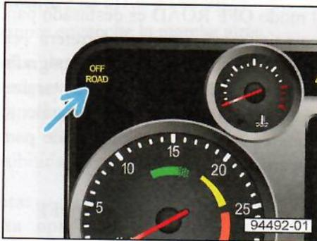
**OFF ROAD** Una luz en el panel permanece encendida mientras el modo OFF ROAD está activo. Cuando se pulsa el botón del modo OFF ROAD, la luz se apagará y se activará el modo ON ROAD.
