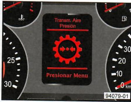
Si se identifica por el módulo principal de la caja una baja presión de aire en el sistema, una indicación en la pantalla de informaciones al conductor será presentada, informando sobre funcionamiento comprometido del sistema de cambio de marchas.
