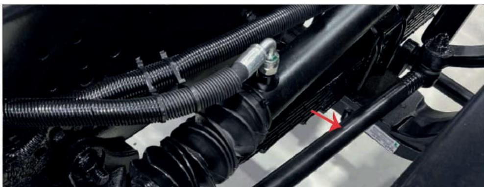
• Barra de dirección del segundo eje | BG1422335AV
