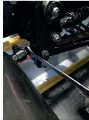
Coloque la llave 1" 5/16 " en la tuerca interior al final de la barra y al girarla al expandirla o comprimirla hace que la barra aumente o disminuya su tamaño, corrigiendo la diferencia después de ensamblar la barra.
