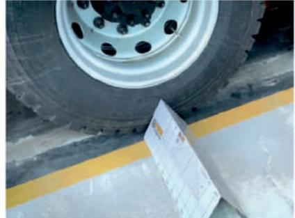
Conecte y proyecte los láseres de las garras en las escalas de las reglas milimétricas (1), sume los dos valores encontrados, uno de cada lado y divida por 2. Coloque las reglas trapezoidales (2) encima de las reglas milimétricas en el valor encontrado en la división. Después de eso, mueva manualmente una de las ruedas hacia adentro o hacia afuera hasta que los láseres estén sobre el valor encontrado en la división.
